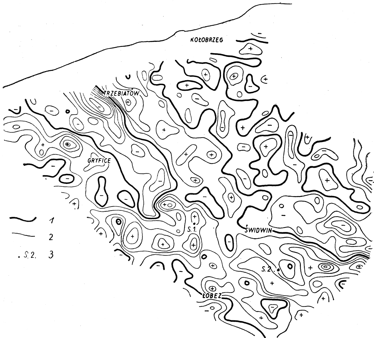
Fig. 6. Anomalie drugich pochodnych pionowych siły ciężkości w rejonie Świdwina — Trzebiatowa obliczone wzorem I T. Elkinsa, s = 2 km. 1 — izolines zerowa; 2 — izolines co 10 \cdot 10^{-15} cgs; 3 — wiercenia
